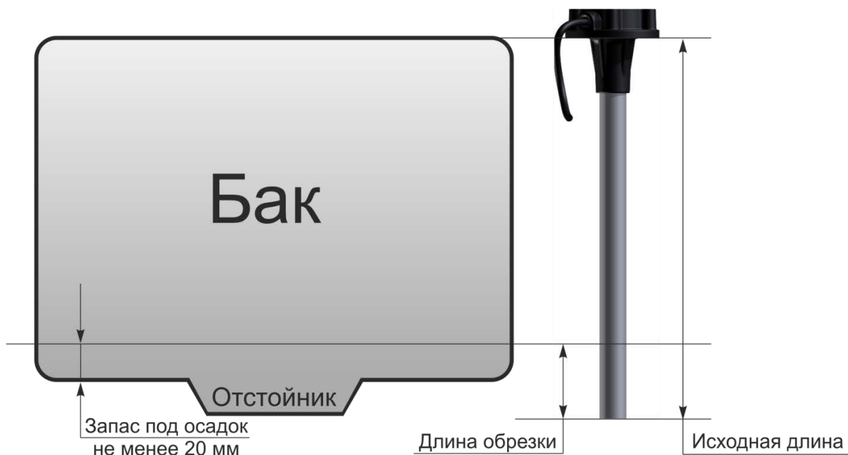
Рисунок 9 – Схема обрезки датчика
