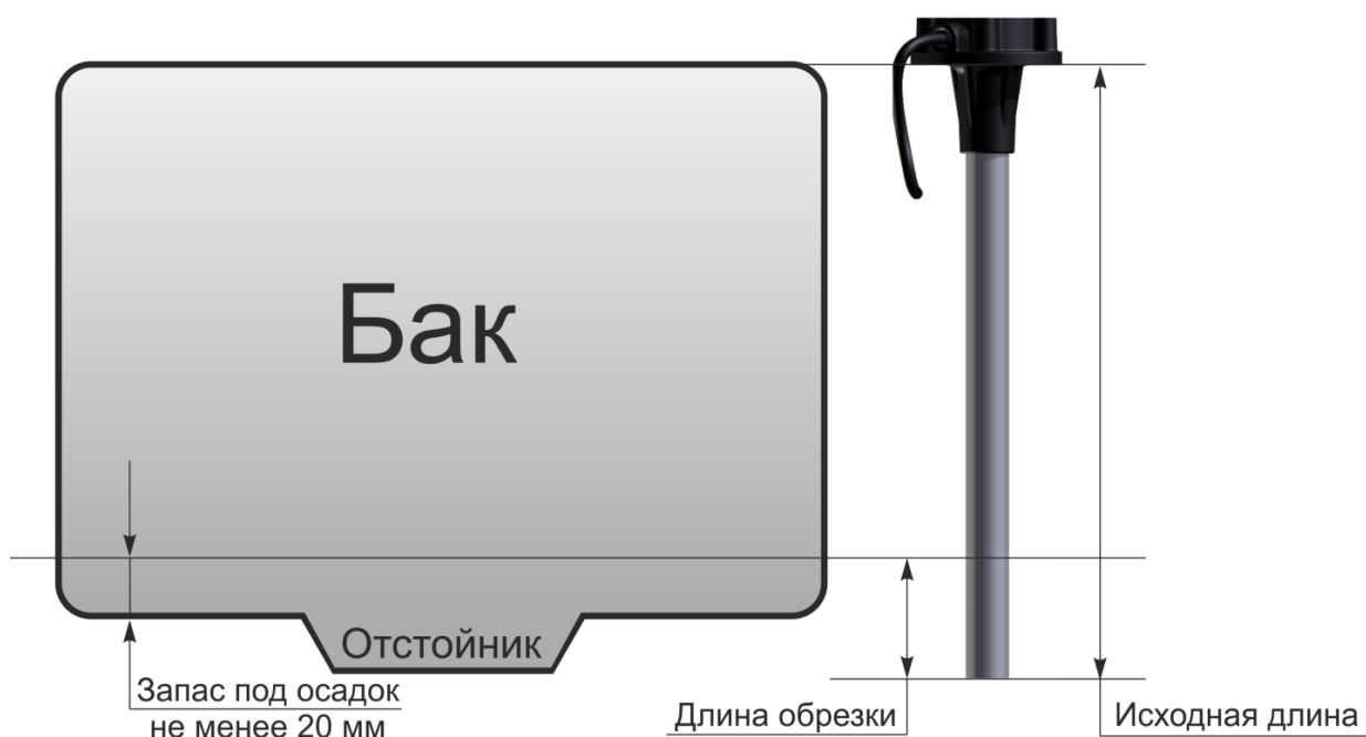
Рисунок 15 – Схема обрезки датчика
